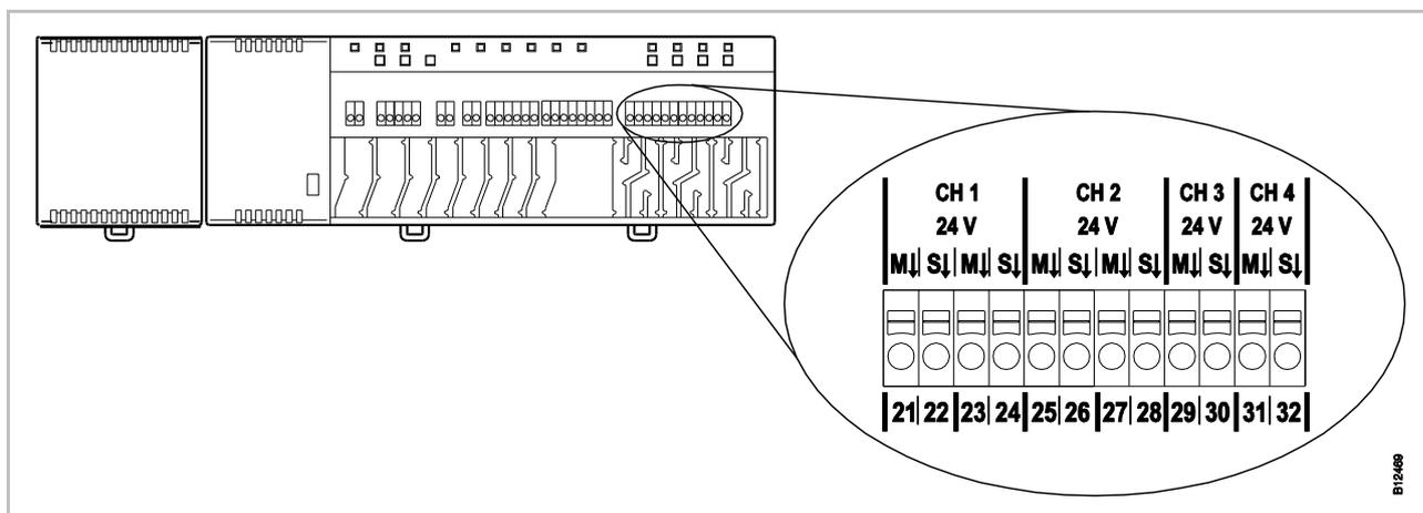
Fig. 28: Connect thermal actuators
