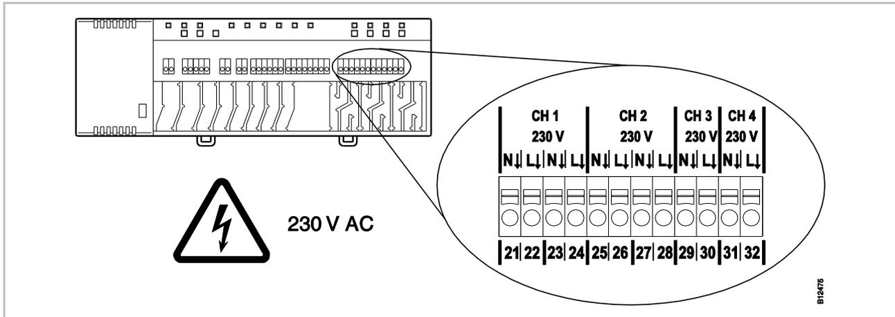
Fig. 40: Connect thermal actuators
