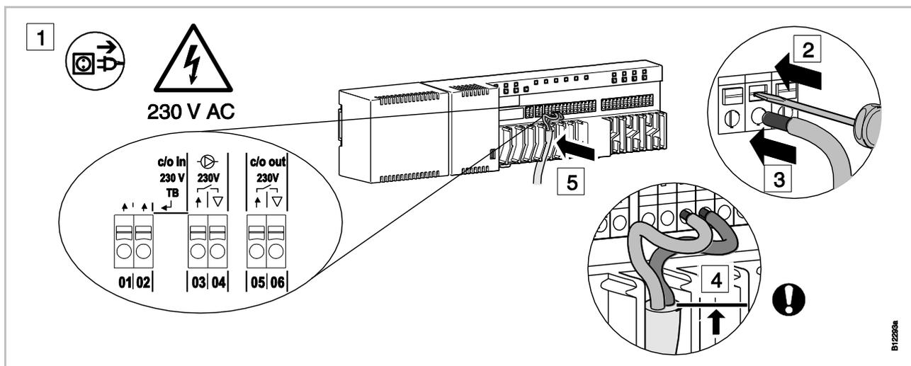
Fig. 26: Connect wires
