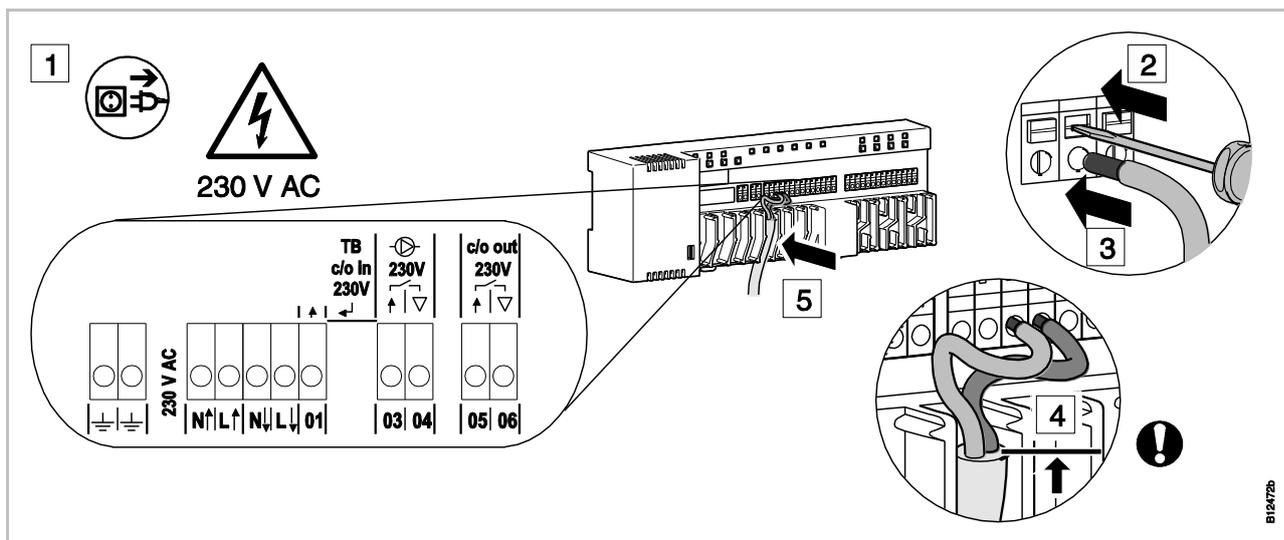
Fig. 39: Connect wires
